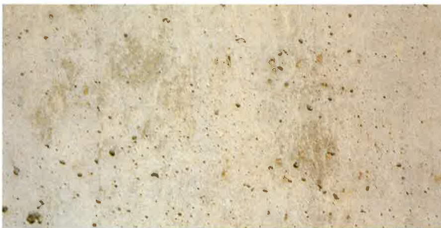
Eksempel på poredannelse hidrørende fra forkert valg eller forbehandling af formmateriale.
