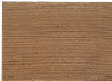
Almindelig søstensbeton med kostet overflade.
