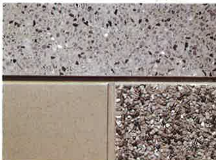
Slebet, afsyret og frilagt overflade med Bayergrün 10/20 (tysk tilslag).
