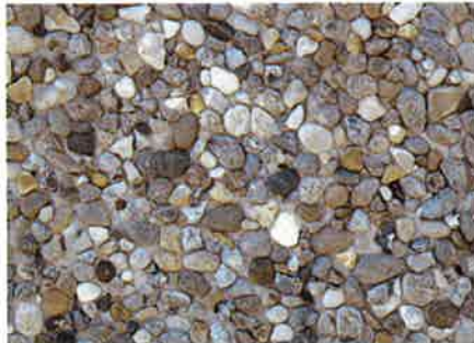
Frilagt overflade med sønøddesten 16/32.
