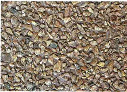
Grå beton med frilagt Uddevalla granit.
