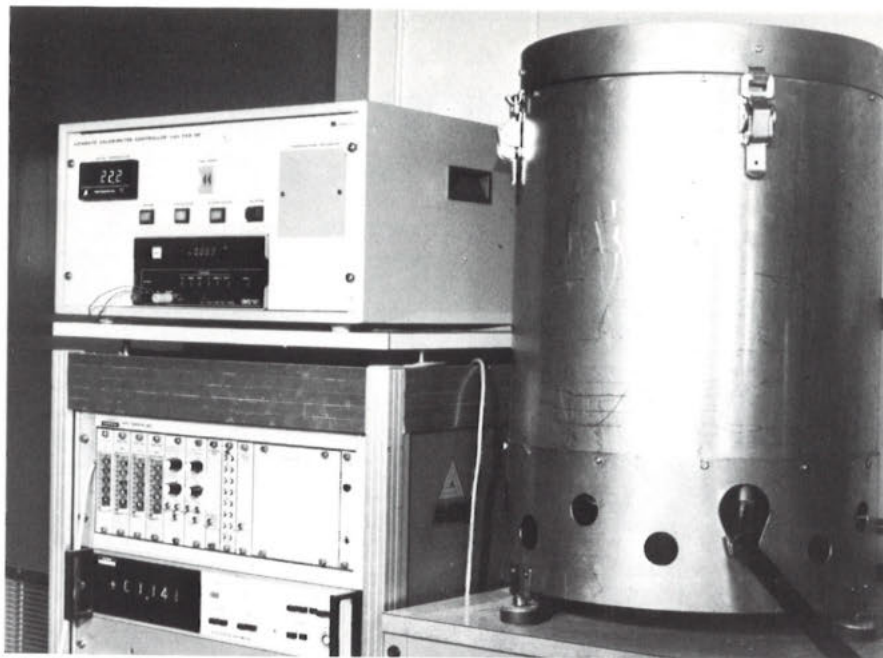
Figur 1b. CBL's adiabatiske kalorimeter.
