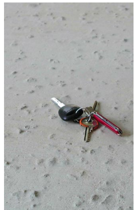
Figur 18. SCC med lette korn der giver ujævnheder i overfladen.
