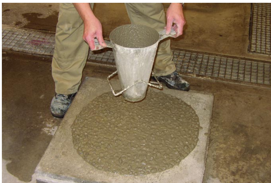
Figur 14. Forskellige metoder til kontrol og undersøgelse af SCC's bearbejdelighed. (A) Udbredelsesmål, (B) J-ring, (C) L-Boks og (D) BML-viskosimeter.
