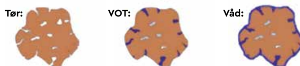
Figur 1 – Grafisk fremstilling af våd overfladetør tilstand (VOT) for tilslagspartikel.
